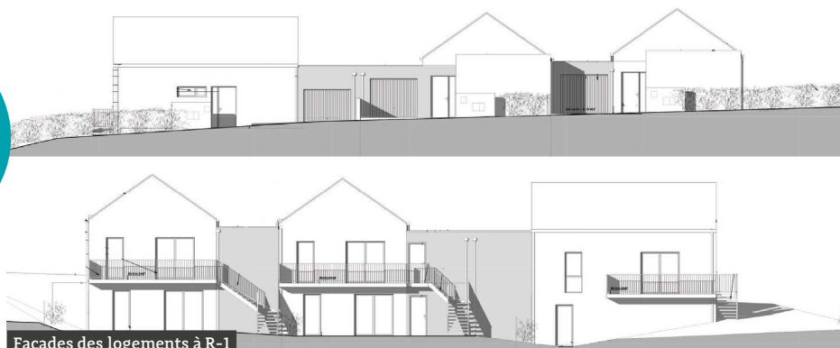
Façades des logements à R-1 Balcon de 10 m 2 avec escalier permettant l'accès au jardin
